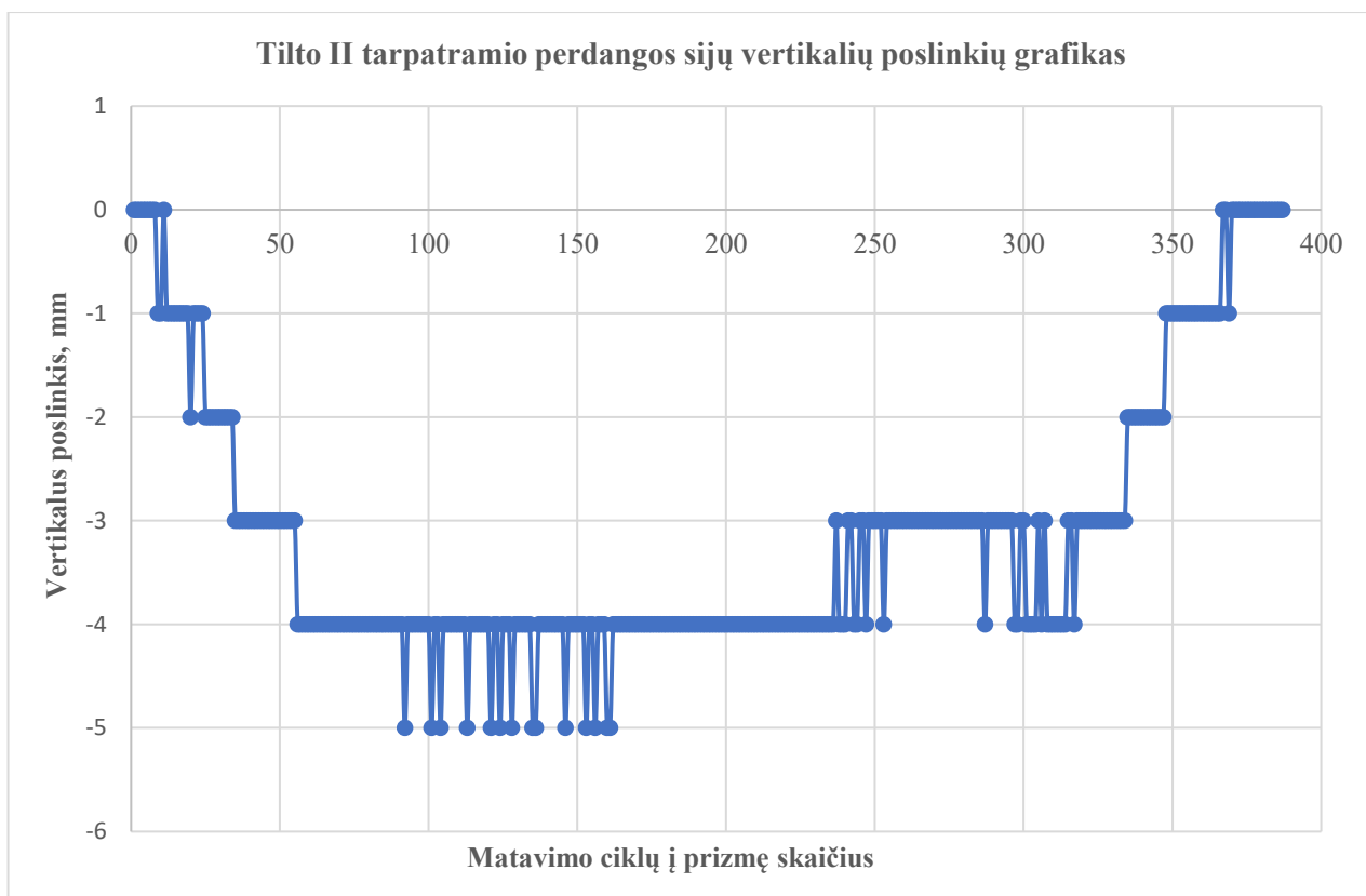
93 pav. Tilto per Nerį II tarpatramio perdangos vertikalūs poslinkiai užfiksuoti nuo tilto važiuojančių sunkiasvorių transporto priemonių apkrovų
